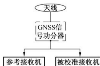
图 4 接收机内部噪声校准示意图（实际 GNSS 信号）
