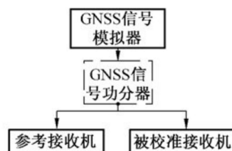
图 3 接收机内部噪声校准示意图（仿真 GNSS 信号）
