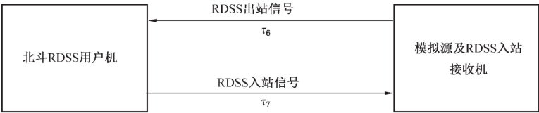
图 E.2 双向设备时延校准
