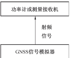
图 4 模拟器信号输出功率控制校准
